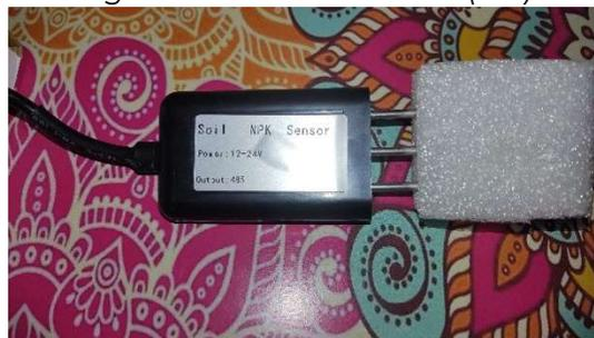
Figura 8 Sensor de nitrógeno, fósforo y potasio (NPK)
