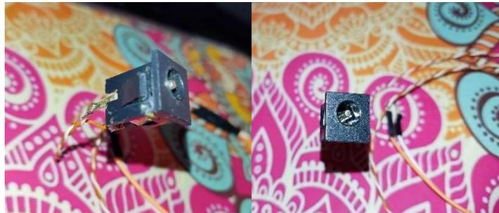
*Figura 21 Conector de alimentación DC*
