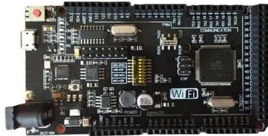
Figura 1 Placa Arduino Mega
