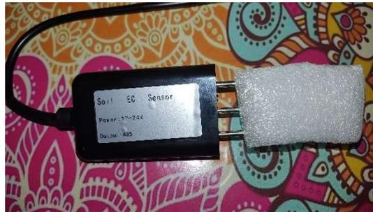
Figura 6 Sensor de Conductividad Eléctrica
